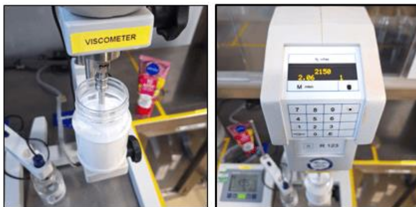
Gambar 4.22 Pengecekan Viskositas Bulk dengan Viscometer
