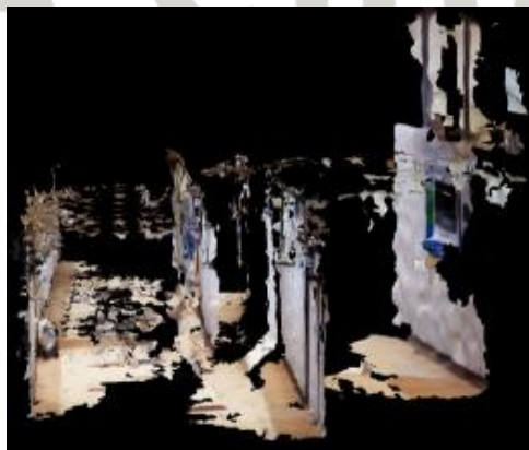
Gambar 4.4 Hasil mapping yang gagal pada lorong C
