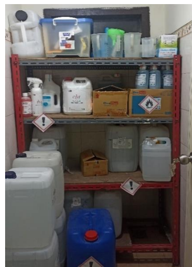
Gambar 2.14 Tempat Penyimpanan B3
