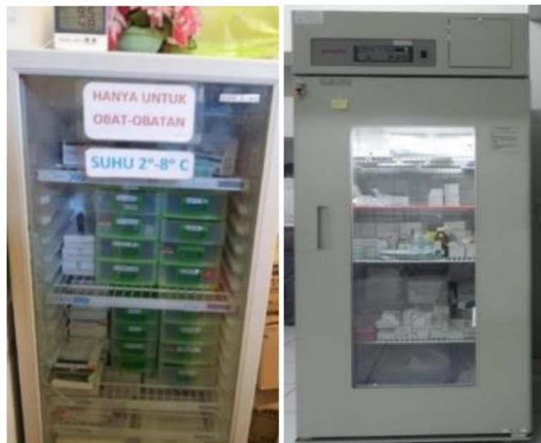
Gambar 2. 8 Lemari Pendingin dengan Termometer Eksternal (Kiri) dan Lemari Pendingin dengan Termometer Internal (Kanan)
