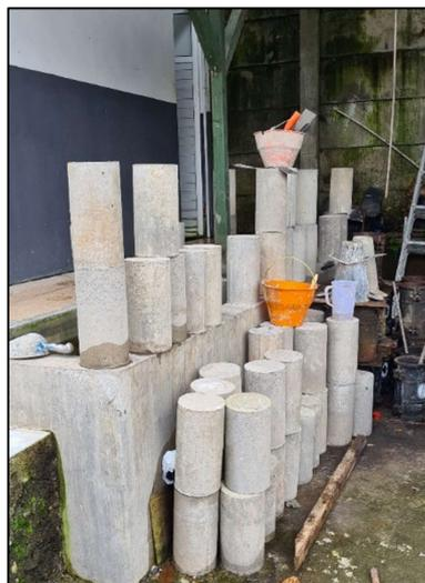
Gambar 2.1 Contoh Beton Hasil Uji
