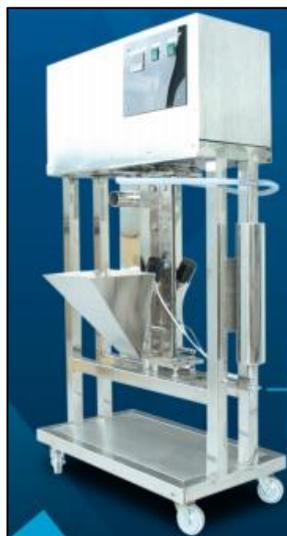
Gambar 2.11 Mesin *Stretching* Keju
