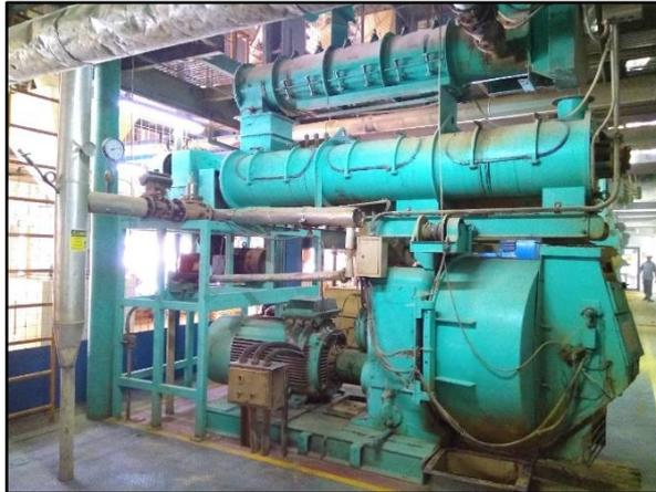
Gambar 2.14 Mesin *Pellet*
