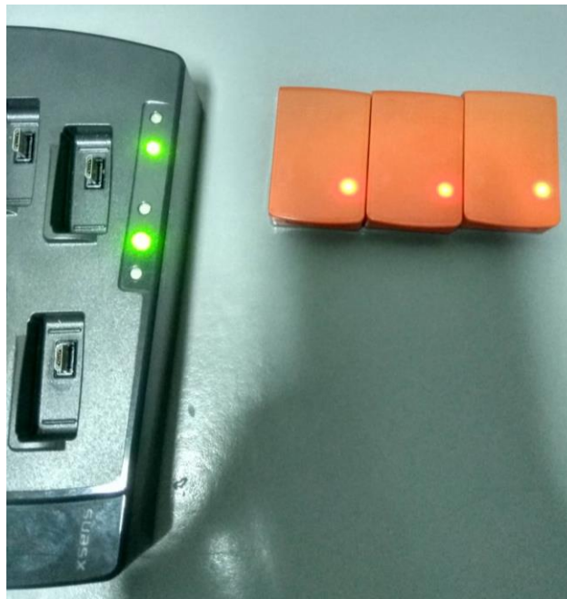
Gambar A. 6 Nyala lampu sensor selaras dengan Awinda Station
