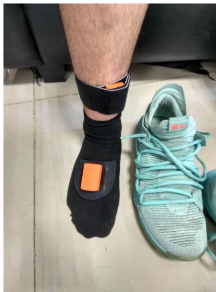
Gambar 3.3 Letak sensor kedua dan ketiga
