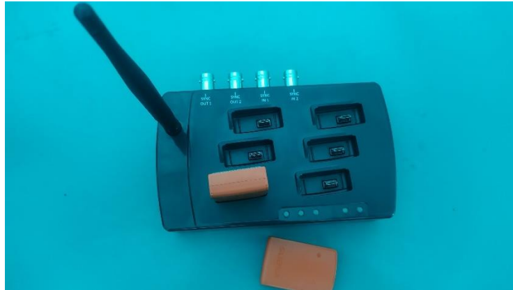
Gambar 3. 3 Awinda Station sebagai receiver
