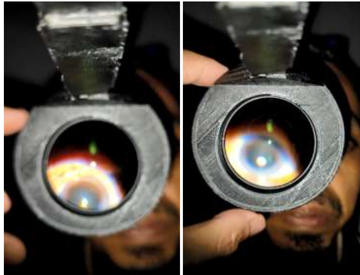
Gambar 4.21 Penangkapan citra fundus dengan lensa 20D, adaptor, dan smartphone
